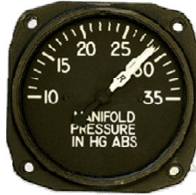
מד לחץ סעפת יניקה: הוא המכשיר לפיו נדע מה הכוח של המנוע.
