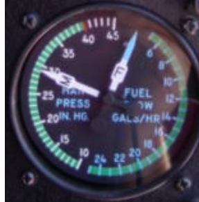
במטוסים מסוימים מד לחץ סעפת יניקה ישולב יחד עם מד תצרוכת דלק
